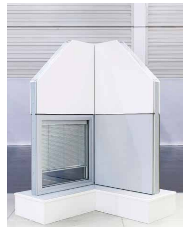
Innovatives Fassadenelement, das mit einer Wanddicke von nur 12 cm bei einem U-Wert von 0,15 W/(m 2 K) Passivhaus-Standard erreicht. Das Element hat die Feuerwiderstandsklasse F90 bei gleichzeitig hoher Schallschutzklasse 5 mit 49 dB.
