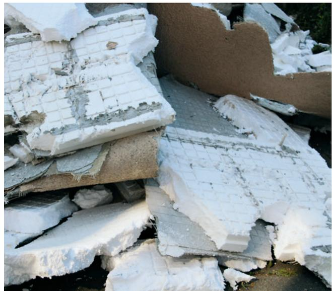
Dämmstoffe mit größeren Anhaftungen gelten als Mischabfälle. Foto: Fraunhofer Institut für Bauphysik (IBP).
