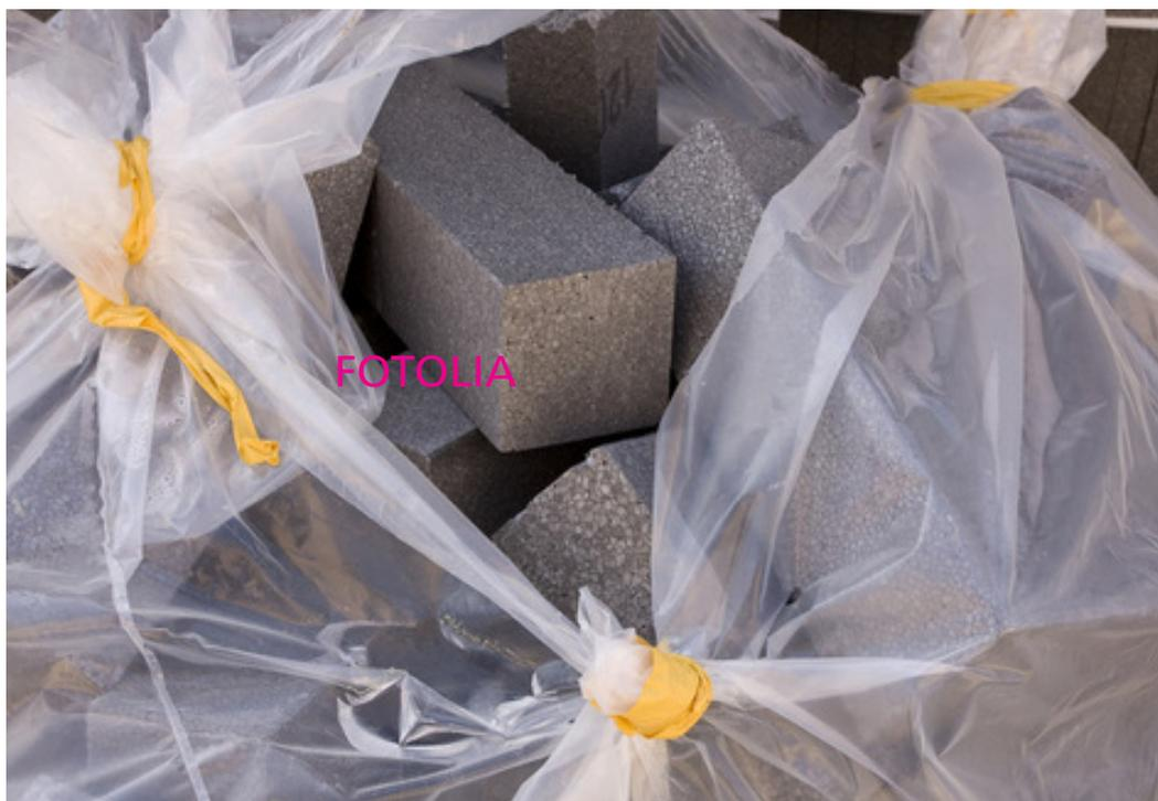
Dämmstoffverschnitt aus der Neuanbringung kann in Rückholsäcken gesammelt und wiederverwertet werden.
